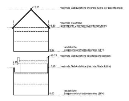
Die Firsthöhe wird gemessen von der tatsächlichen Erdgeschossrohfußbodenhöhe (EFH) bis zum Schnittpunkt der Oberkante der Dachhaut beider Dachflächen (Sattel- und Walmdach). (vergl. Höhenlage von Gebäuden).
